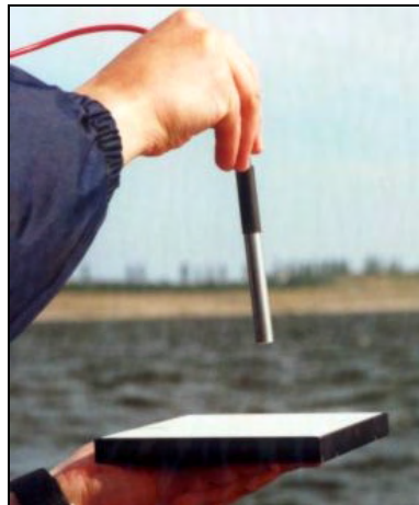
Abb. 5.3 Messung der aufwärtsgerichteten Strahldichte einer Spektralplatte über Wasser L_u(0+) .
